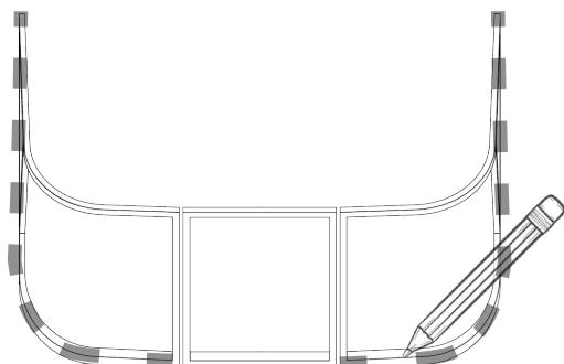
Очерчиваем контур рамки карандашом для наклеивания уплотнителя (под рамку) с клеевой основой.
