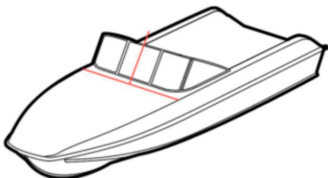
Выставить рамку на лодке, определить места прилегания ветрового стекла.
