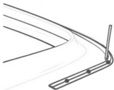
С помощью пробойника (шило, отвертка), в местах крепления рамки, делаем отверстия в уплотнителе, чтобы предотвратить налипание на винты kleевой основы.
