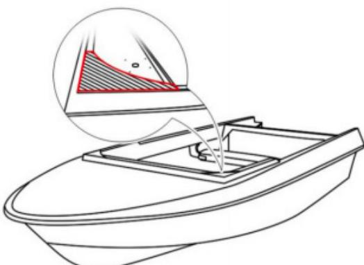
Приклепать специальные алюминиевые элементы уголки (идут в комплекте) пройтись герметиком в местестыка пластиин и заводского посадочного места.
