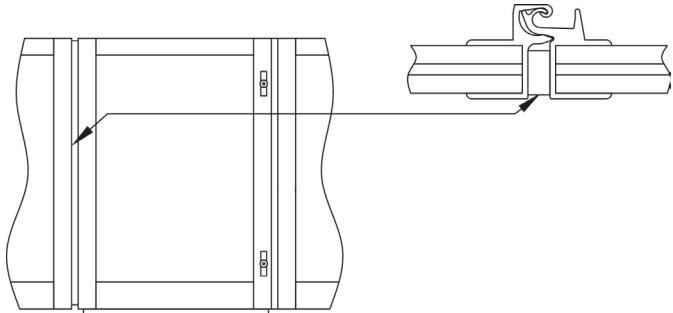
Наклеиваем уплотнитель 6x12 в проём калитки.
